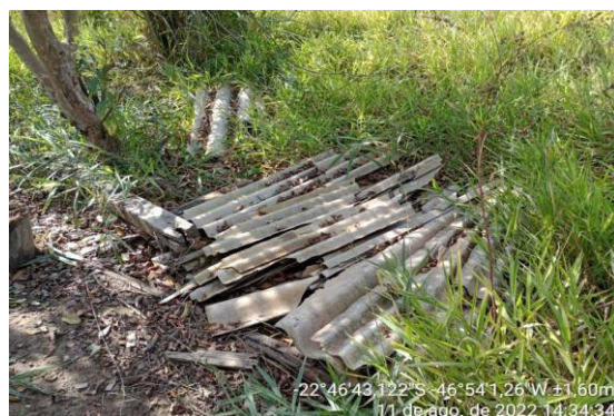
Foto 3 - Telhas de amianto
